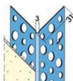
Kantenprofil aus verzinktem Stahl, für Innenputze ab 1 mm, zum Einspachteln von Gipskartonkanten. Mit langen Spachtelschenkeln zur Rissüberbrückung im Schnittkantenbereich
