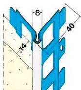
PROTEKTOR Kantenprofil aus verzinktem Stahl mit PVC-Überzug, für Innen- und Aussenputze ab 14 mm
