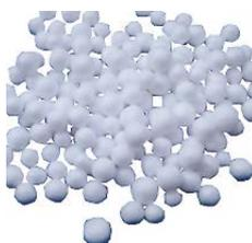
EPS Perlen, loses Schüttmaterial. Anwendungsgebiet: Zuschlagsstoff für zementöse Gewerke (Leichtbeton), Gartenbau (Erdlockerung) und Füllmaterial
