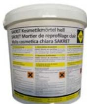
Hydraulisch erhärtender, kunststoffvergüteter, zementärer Werk trockenmörtel. Zum Reparieren und Ausbessern von Sicht- und Normalbeton. Zur grossflächigen Überarbeitung poröser Oberflächen. Für Wand, Decke und Boden im Innen- und Aussenbereich. Frostbeständig. Nicht korrosionsfördernd. In einem Arbeitsgang bis max. 10 mm Schichtdicke verarbeitbar
