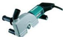
Mauernutfräse Ø 180 mm. Leistungsaufnahme 1'800 W, Leerlaufdrehzahl 4100 U/min, Schlitzbreiten von 9 bis 43 mm, Schnitt-Tiefe von 15 bis 60 mm, Ø Scheiben 180 mm, Bohrung 22,23 mm, Gewicht 6,0 kg.
