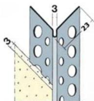
Kantenprofil aus Aluminium für Innenputze ab 3 mm. Kantenprofile aus Aluminium können in privat genutzten häuslichen Bädern, auch unter Fliesen, eingesetzt werden. In gewerblichen Küchen und sonstigen Feuchträumen, Schwimm- und Hallenbädern, sowie bei Verwendung von Sanierputzen sind Edelstahlprofile einzubauen
