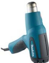
Heissluftgebläse. Leistungsaufnahme 1600 W, Heizleistung 350°C / 500°C, Luftmenge 350 / 500 l/min, max. stat. Druck 1500 Pa, Temperatur und Luftmenge in 2 Stufen wählbar, Überhitzungsschutz, Gewicht 680 g.
