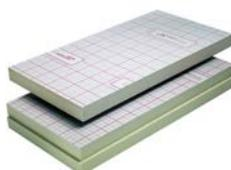
Polyurethan-Hochleistungs-Dämmstoffplatten sind ökologisch und ökonomisch sinnvolle Wärmedämmungen. Anwendungsgebiet: Neubau und Renovation. Wärmedämmung von Flach- und Steildächern (Warmdach). Wärmedämmung von Böden - unter schwimmenden Estrichen oder unter Lastverteilschichten
