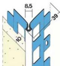
PROTEKTOR Kantenprofil aus verzinktem Stahl, mit PVC-Überzug, für Innen- und Aussenputze ab 10 mm
