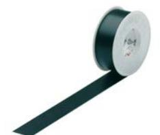
Elektro-Isolierband. Weich-PVC. Acrylatkleber. Das PVC-Klebeband Coroplast 302 wird für alle normalen Isolierarbeiten, u.a. Reparaturen beschädigter Isolationen, Umwickeln von Kabelenden und Abzweigungen und zum Kennzeichnen des Schutzleiters (grüngelb) verwendet. Das Band ist schwer entflammbar und besitzt eine sehr gute Alterungsbeständigkeit
