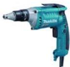
Elektronik-Schrauber 0-6000 U/min. Werkzeugaufnahme 1/4" (Innensechskant), Leistungsaufnahme 570 W, Drehzahl stufenlos 0-6000 U/min, Ideal für Gipskartonplatten auf Metallunterkonstruktion, Bit- und Führungshülse-Halterung, stufenlose Geschwindigkeit, Schnellbauschr. max. Ø 5 mm, Gewicht 1.4 kg.
