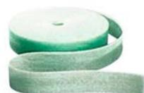
Universell einsetzbarer Randdämmstreifen aus Polyethylschaum. Elastisch. Verrottungsfest. Wasser- und säurebeständig. Anwendungsbereich: Schallbrückenfreie Verlegung schwimmender Estriche jeder Art, als Trennung des Estriches vom Mauerwerk oder sonstiger Einbauten
