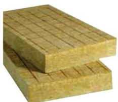
Wärme- und Schalldämmung in hinterlüfteten Fassaden. Flumroc-Dämmplatte DUO D20 werkseitig auf der verdichteten Oberfläche mit einem Abstand von 200 mm für die Montage der Alu-Winkel geschlitzt. Die Hinterlüftungslatte wird mit Distanzschrauben auf das Tragwerk im Lot verschraubt. Einseitig verdichtet. Geschlitzt in der verdichteten Zone. Nicht brennbar. Wasserabweisend. Diffusionsoffen. Mit Rastermarkierung. Schnell und einfach zu verarbeiten. Recyclebar
