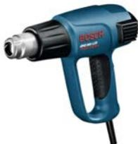
4 Hauptanwendungen können fest gespeichert werden, so dass Luft und Temperatur sofort richtig eingestellt sind. Luft- und Temperaturregulierung in Zehnerschritten für präzises Arbeiten, Anzeige über LCD-Display. Automatisches Abschalten der Heizung und Kühlen bei Überhitzung für lange Lebensdauer. Arbeitstemperatur 50 - 600 °C, Luftstrom 250 - 500 l/min, stufenlose Temperaturregelung, Kaltstufe 50 °C, Regulierung Luftstrom stufenlos. Nennaufnahmeleistung 2300 W, Gewicht 1.0 kg, Höhe 255 mm.
