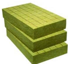
Wärme- und Schalldämmung in hinterlüfteten Fassaden sowie im Zweischalen-Sichtmauerwerk. Der zweischichtige Aufbau der Steinwollplatte mit einer elastischen unteren Seite und einer härteren Aussenschicht macht DUO zur perfekten Dämmung für Aussenwände. Eine Rastermarkierung erleichtert den Zuschnitt
