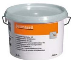
Lösungsmittelfreier Spezialkleber, mit dem das Armierungsband HD überstrichen wird, welches beim Einsatz der Powerpanel HD als temporär wirksamer Wetterschutz oder als Putzträgerplatte auf die Plattenstösse aufzubringen ist. Verbrauch ca. 60 g pro laufende Meter-Fuge
