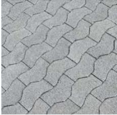
Der UF Sickerstein ist ein wasser- und luftdurchlässiger Betonpflasterstein, der eine Fläche gleichmässig befestigt, ohne sie zu versiegeln. Dieser Stein gewährleistet die Oberflächenentwässerung und erreicht damit eine Verringerung der Abflussmengen in die Kanalisation. Im Bereich von befestigten Nutzflächen werden die Wurzeln von Sträuchern und Bäumen ausreichend belüftet und mit Niederschlagswasser versorgt
