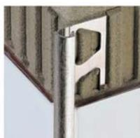
Schlüter-RODEC-AE eloxiert ist ein symmetrisch gerundetes Profil mit Fugensteg für Wandaussenecken und Belagsabschlüsse aus Aluminium mit natur matt eloxierter Oberfläche. Durch den Fugensteg wird eine definierte Fugenkammer zur Fliese vorgegeben
