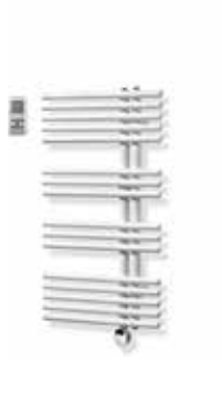
596 510 – 596 511 Badheizkörper Pavone E, Öffnung links, Anschluss elektrisch 230 V, Heizstab rechts, Infrarot Thermostatsteuerung SP1, IP44, Fernbedienung programmierbar, Befestigungsmaterial 596 510: 51 x 85,6 cm, 700 W 596 511: 61 x 85,6 cm, 700 W
